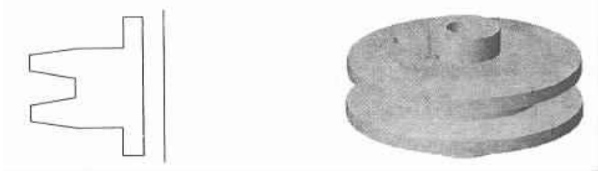
图 1 滑轮横截面轮廓图 图 2 滑轮立体图
