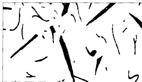
图2 美国标准及国际标准中的C型石墨 Fig.2 C-type graphite in USA standard and international standard
