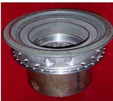
图1 西北工业大学激光组合制造航空发动机零件（下部为 In961 不锈钢铸件，并经局部激光修复；上部为 4169 镍基合金激光成形体）
