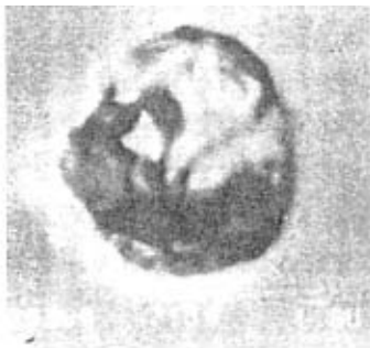
图 2 变质后球粒状夹杂物 800×
