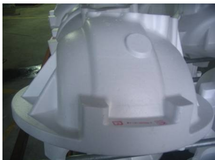
图 13 减速器壳泡沫模样
