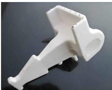
图 17 预埋铁座泡沫模样
