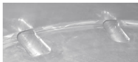
图 3 AGC 伺服液压缸缸底进出油口处裂纹
