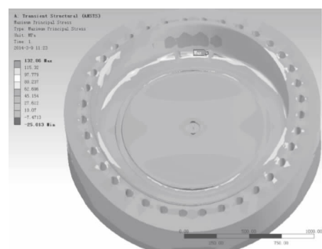
图 6 改进后尺寸第一主应力
