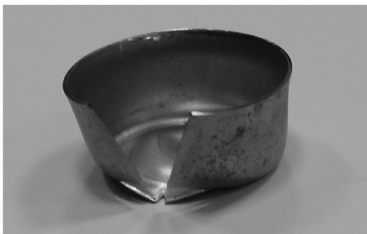
图 1 在低温冲击时产生二次加工脆性的样杯
