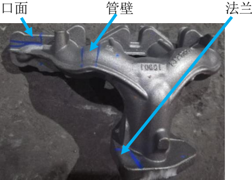
图 7 排气歧管（取样部位）
