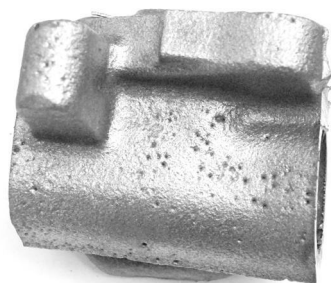
图 2 皮下气孔
