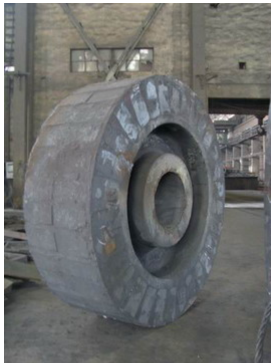
图3 飞轮铸件图
