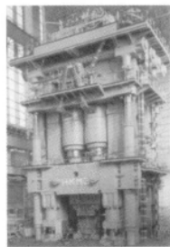
(c) 法国的650 MN多向模锻水压机
