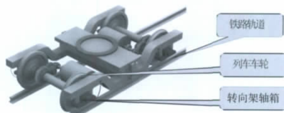
图1 高速动车组转向架工作状态图
