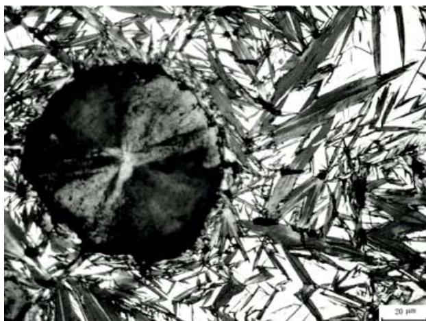
光学放大倍数：400× 浸蚀剂：4%硝酸酒精 材料及状态：球墨铸铁 热处理：淬火 组织及说明：淬火马氏体+残余奥氏体
