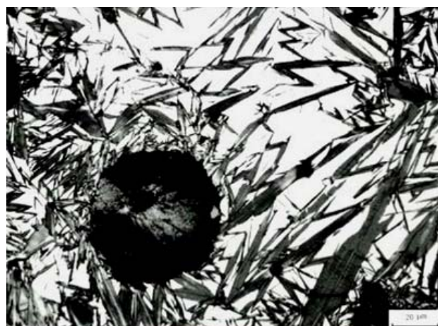
光学放大倍数：500× 浸蚀剂：4%硝酸酒精 材料及状态：球墨铸铁 热处理：淬火 组织及说明：淬火马氏体+残余奥氏体
