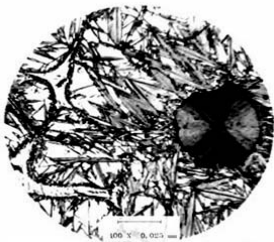
光学放大倍数：400× 浸蚀剂：4%硝酸酒精 材料及状态：球墨铸铁 热处理：淬火 组织及说明：淬火马氏体+残余奥氏体
