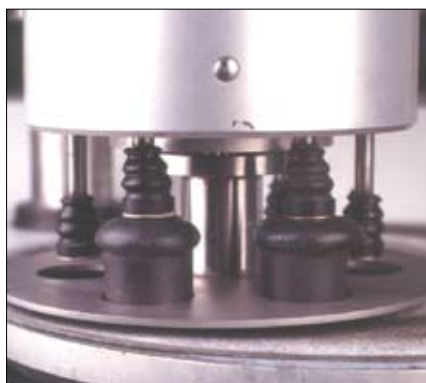
图13: 试样夹具, 用于铸造生产线内质量控制样品的半自动抛光
