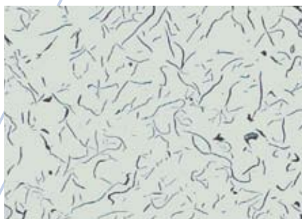
图2: 与图1相同的铸铁, 抛光正确 200x
