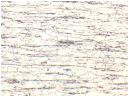
图五: 铁素体不锈钢含有硫化锰与多条的碳化物, 用10%草酸进行电解腐蚀后 200x
