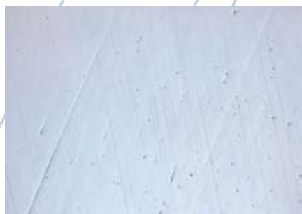
3 μm抛光后的不锈钢表面，图示为研磨产生的形变
