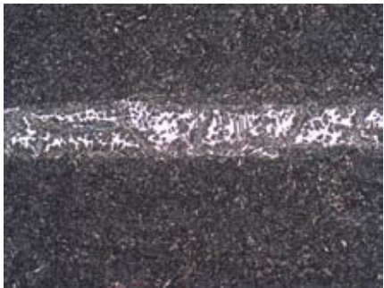
图六: 含有 \delta 铁素体的回火马氏体不锈钢, 使用苦味酸浸蚀 75x
