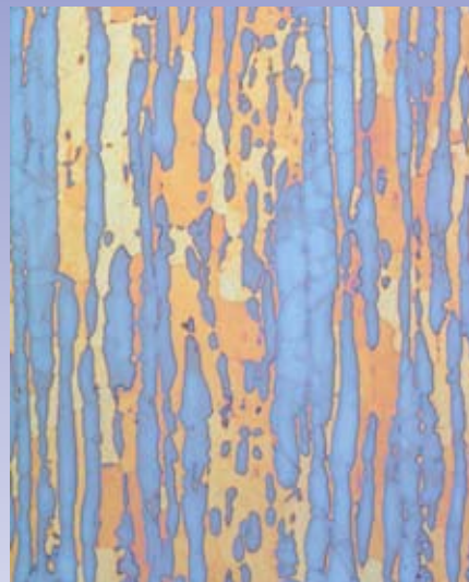
图一：用40%氢氧化钠水溶液进行电解浸蚀的双炼型钢，蓝色为奥氏体钢，黄色为铁素体钢
