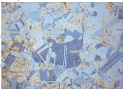
色彩腐蚀(Beraha II)后，未充分抛光的不锈钢，图示为形变
