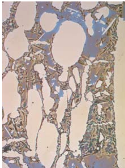
图十：锻造的双重类型不锈钢，如图所示，为蓝色的铁素体、白色的奥氏体与细针状的 \sigma 相图，用40%腐蚀性苏打溶液电解浸蚀
