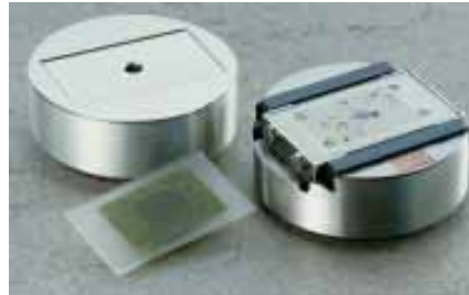
精磨和抛光用薄片试样夹具座
