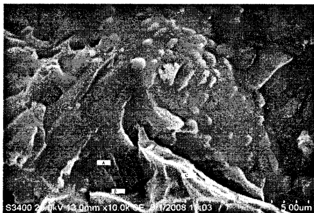
图 4 断口的微观形貌
