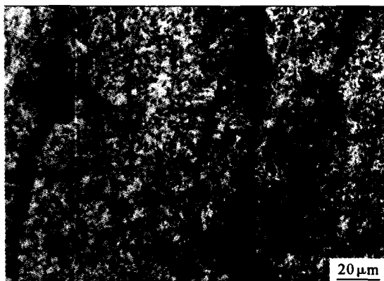
图7 裂纹处轻度腐蚀
