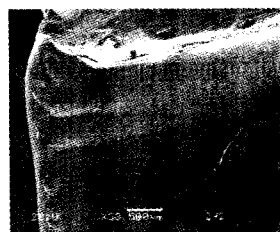
图4 裂缝中部冲刷光滑区形貌(疲劳台阶)×30
