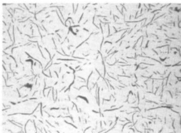
图 2 稀土硅铁孕育组织 100x
