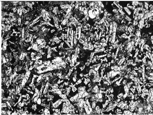
图 2 LF 炉精炼废渣光学显微照片 ×4
