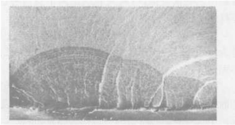
图 17 疲劳断口的宏观形貌
