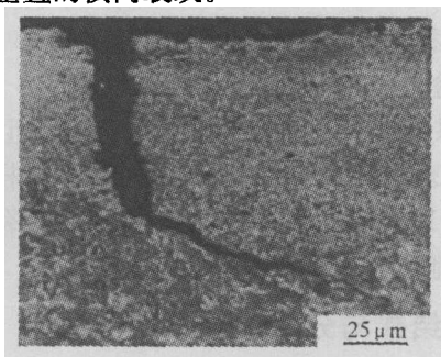
图3 \Phi 3.30\text{mm} 钢丝表层非索氏体组织
