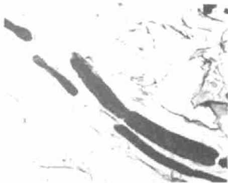
图1 沿晶分布的 \alpha -MnS \times 3600
