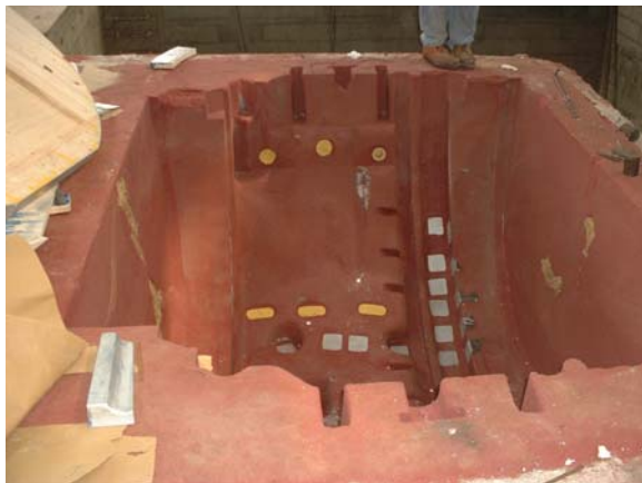
图 3 FENOTEC810 碱性酚醛树脂砂型
