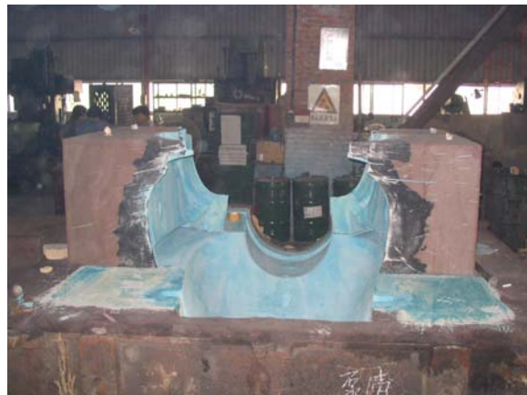
图 3 FENOTEC810 碱性酚醛树脂砂型
