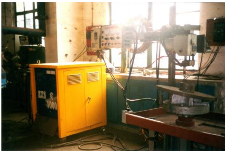
图 15 全套阀门自动堆焊装置近影照片
