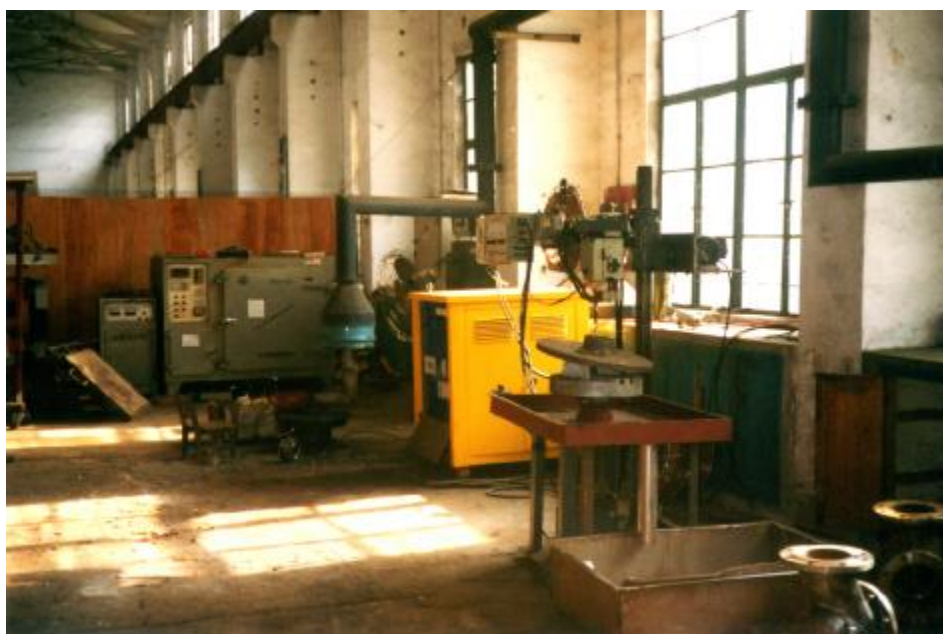
图 15 全套阀门自动堆焊装置近影照片
