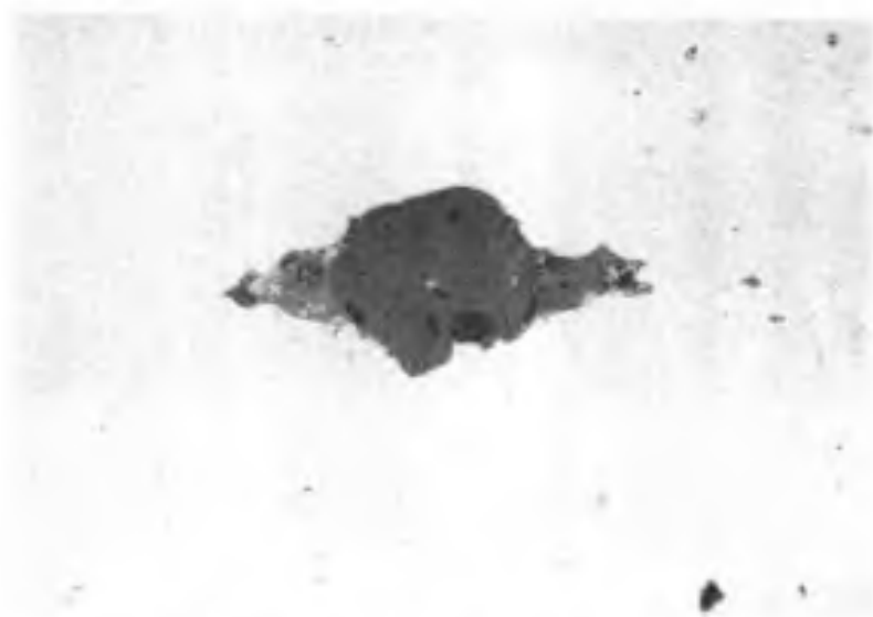
图1.10 明视场下观察的复合夹杂物
