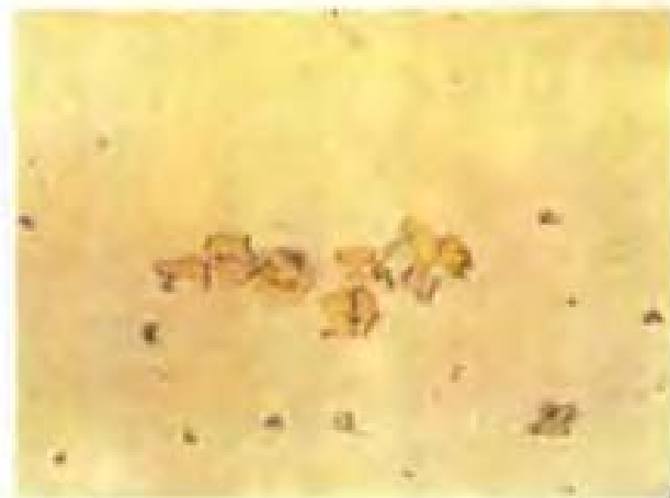
图1.6 氮化钛的彩色照片 氮化钛在明视场下呈亮黄色
