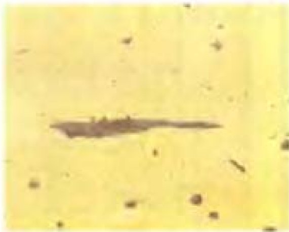
图1.4 硫化锰的彩色照片 硫化锰在明视场观察呈淡兰灰色
