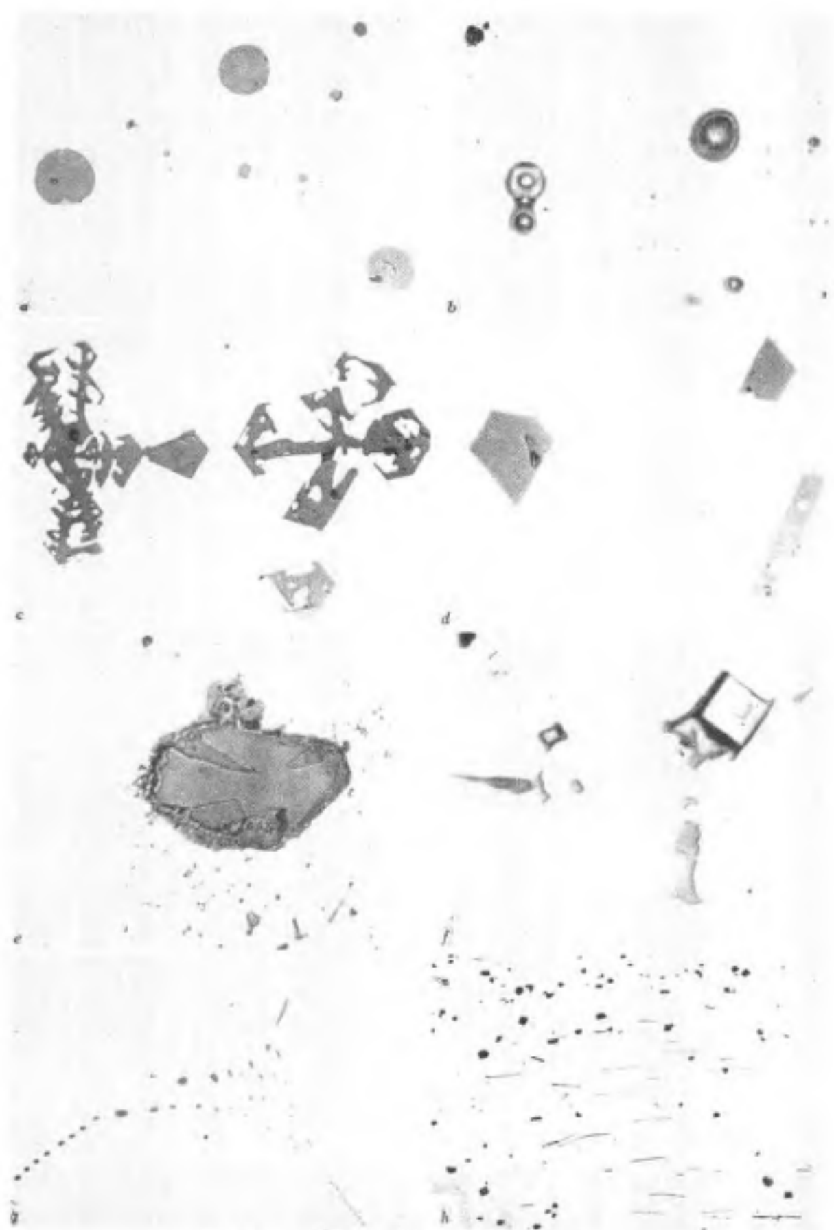
图 1.2 几种具有代表性的夹杂物的形态
