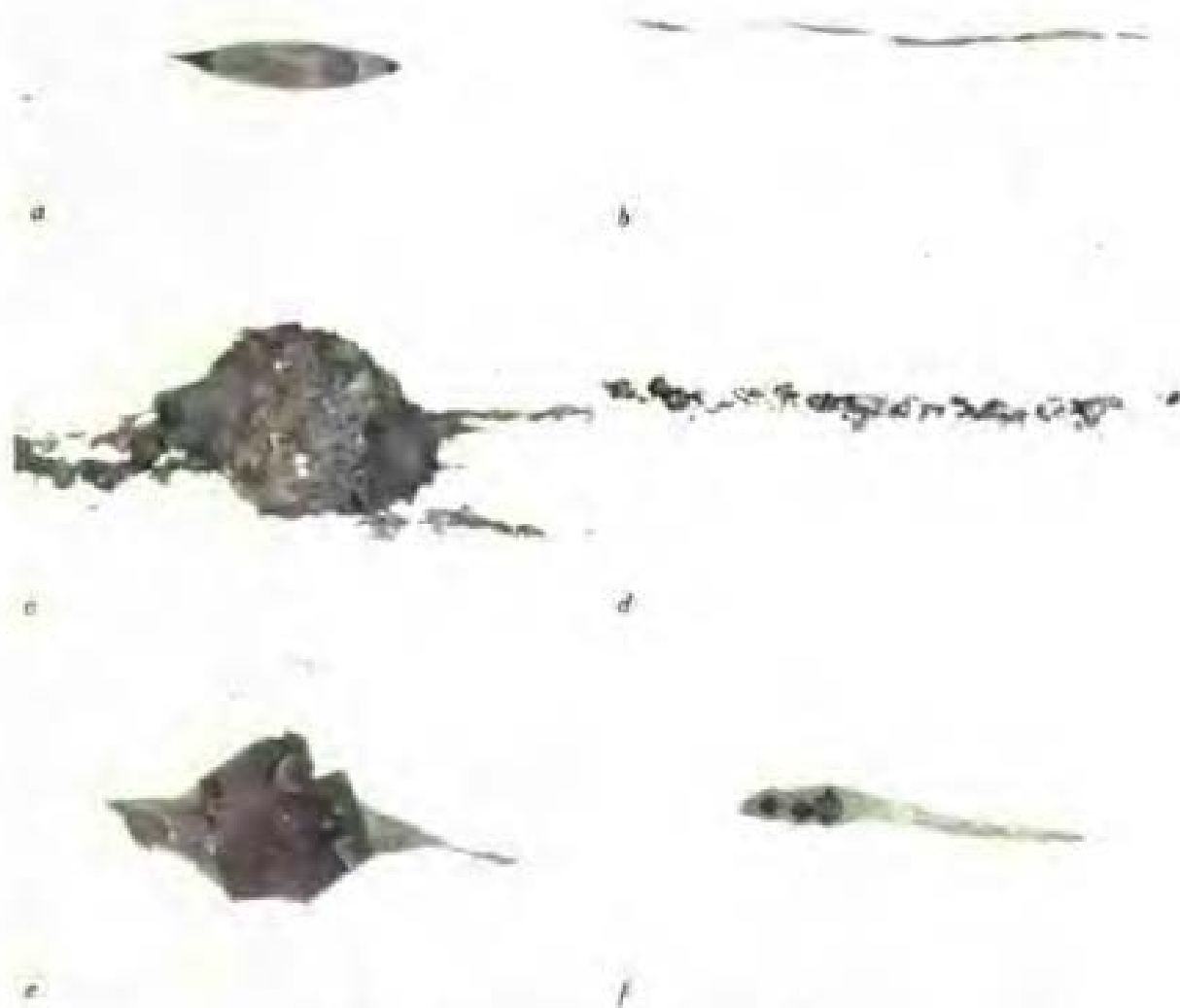
图1.3 经变形后夹杂物的变形行为
