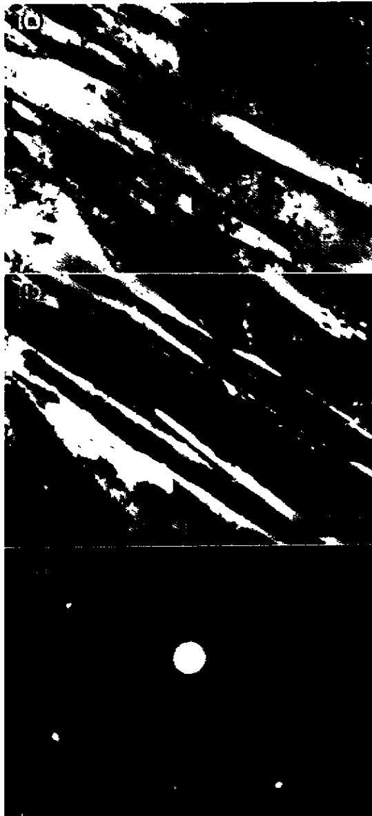
图7 亚临界粗晶区中板条间的 \text{Fe}_3\text{C}
