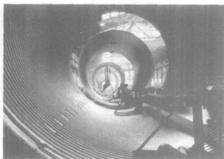
图6 用EAS 4 M—MC 型金属粉芯药芯焊丝 ( \phi 1.2 mm) 焊制的热交换器帽贝管
