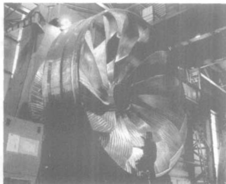
图5 用CN 13/4—MC型金属粉芯药芯焊丝焊接的水轮机
