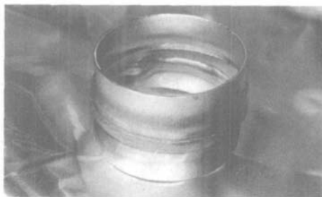
图8 用伯乐 EAS 2—MC 焊接的排气集管 (壁厚仅为 0.6 mm)
