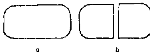
图2 砂粒碎裂后表面积增大的情况
