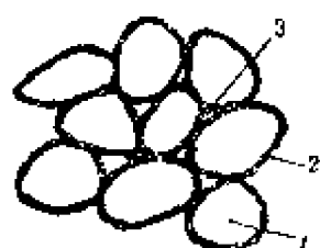
图1 粘土粘结砂粒的简图 1—砂粒；2—粘土薄膜；3—孔隙
