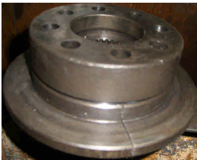
图 5 模芯及预应力圈断裂（压板未裂、但无法拆卸）
