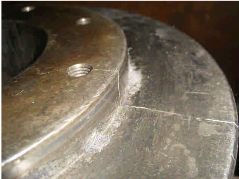
图 7 另一个预应力圈断裂
