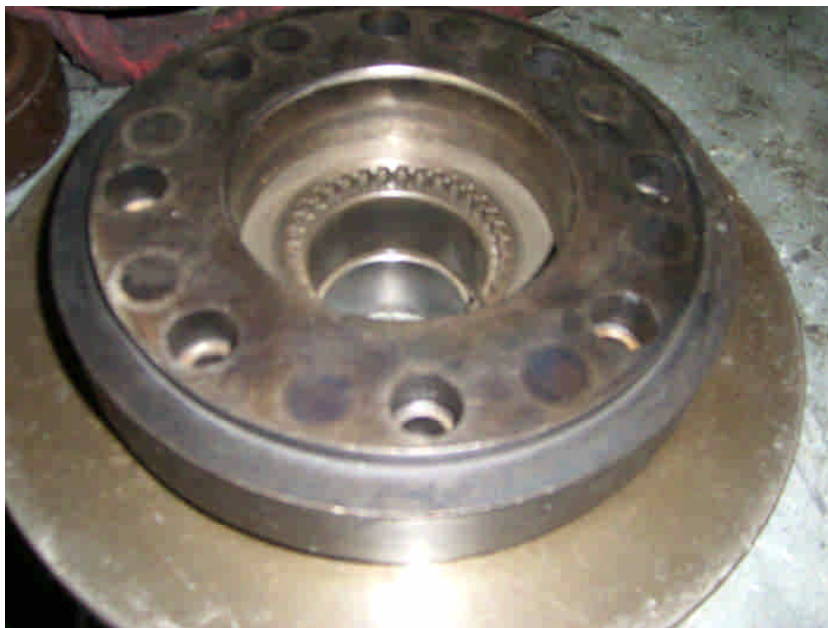
图 8 螺纹位置存在可以往低应力区移动的空间
