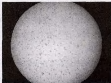
图3 炉前球化检验样石墨状态 100×
