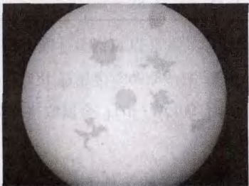
图1 QT400—18 球墨铸铁球化衰退后石墨聚集区开花石墨的显微组织 400×
