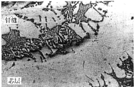
(b) 钎焊后钎缝 50×
