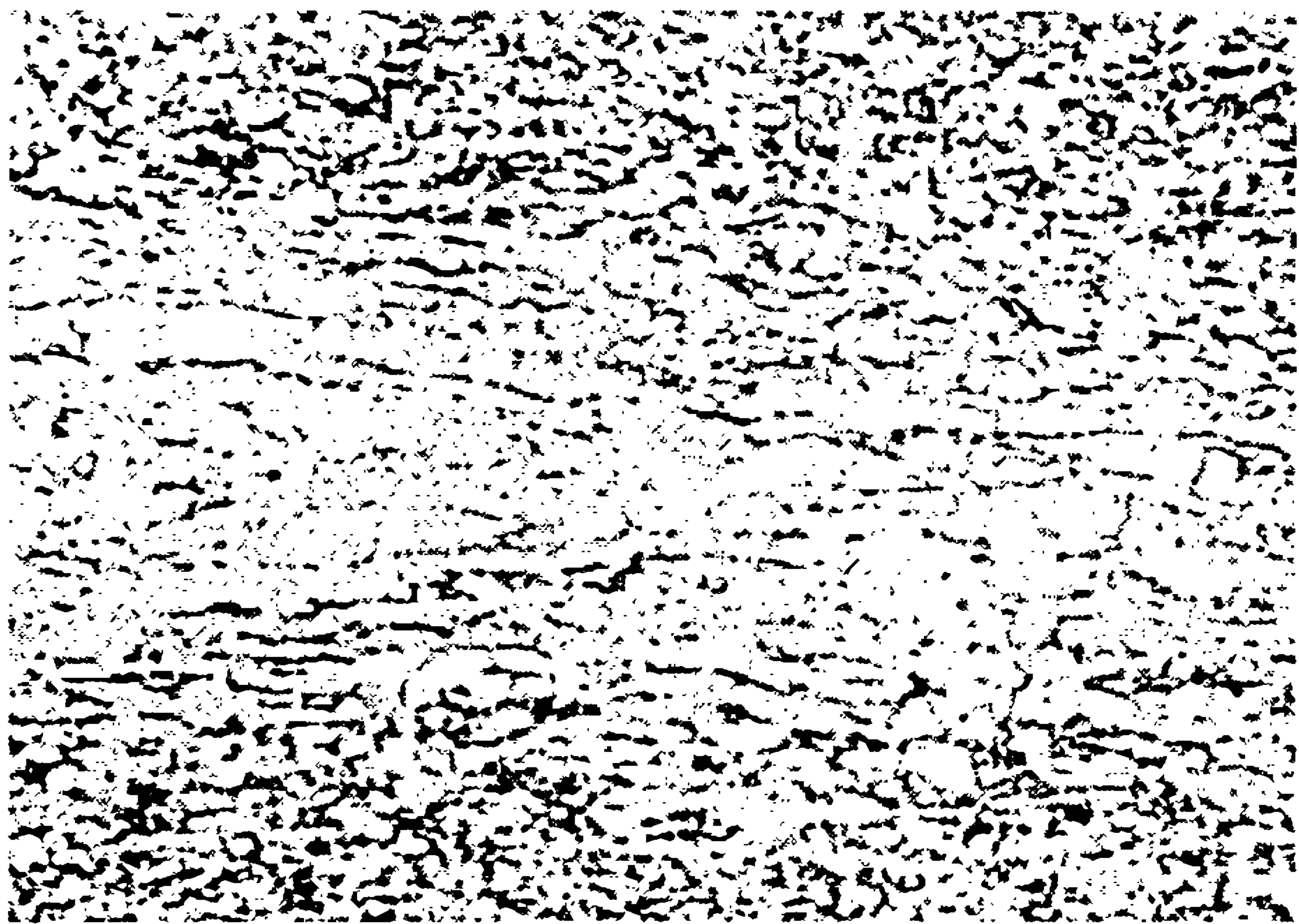
图 30 高间隙缺陷 TC4
